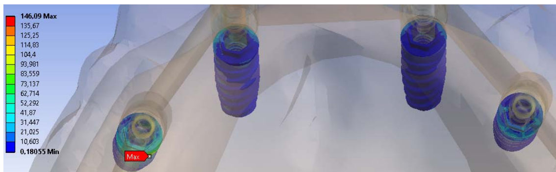
Figura 64: Distribuição das tensões, seguindo o critério de Von Mises (em MPa) nos implantes e máxima tensão encontrada.
