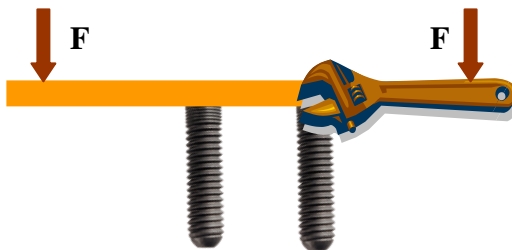
Figura 15 - Esquema representativo do momento atuando em uma extensão em balanço, em associação com a chave de boca.
